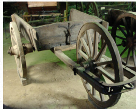
Erdwüppe, die noch bis in die 1950er Jahre zum Transport der Erdmassen diente
